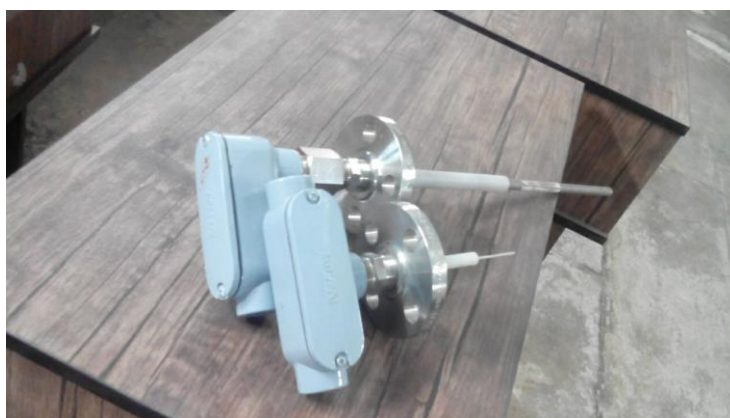
شکل ۵. کاتد و الکتروود مرجع حفاظت آندی ساخت شرکت برنالکترونیک
