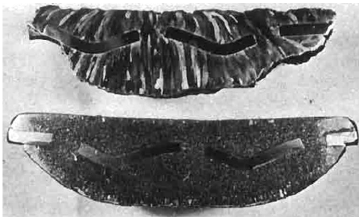
شکل (۲) - ساختار ستونی روی خالص (تصویر بالا) و ساختار ریزدانه آند روی (تصویر پایین) [۱۰]
